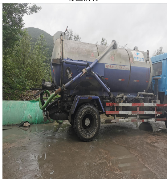
吸污车拉运渗滤液
