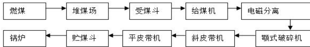
图 3-4 上煤系统工艺流程示意图
