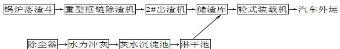
图 3-5 除渣系统工艺流程示意图
