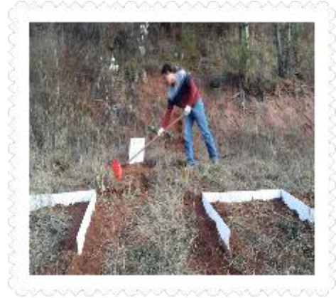
2015年11月建立的开挖面和原地貌径流观测点
