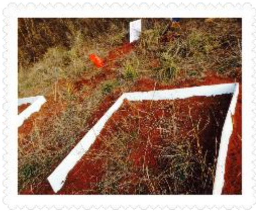
2015年11月建立的开挖面和原地貌径流观测点
