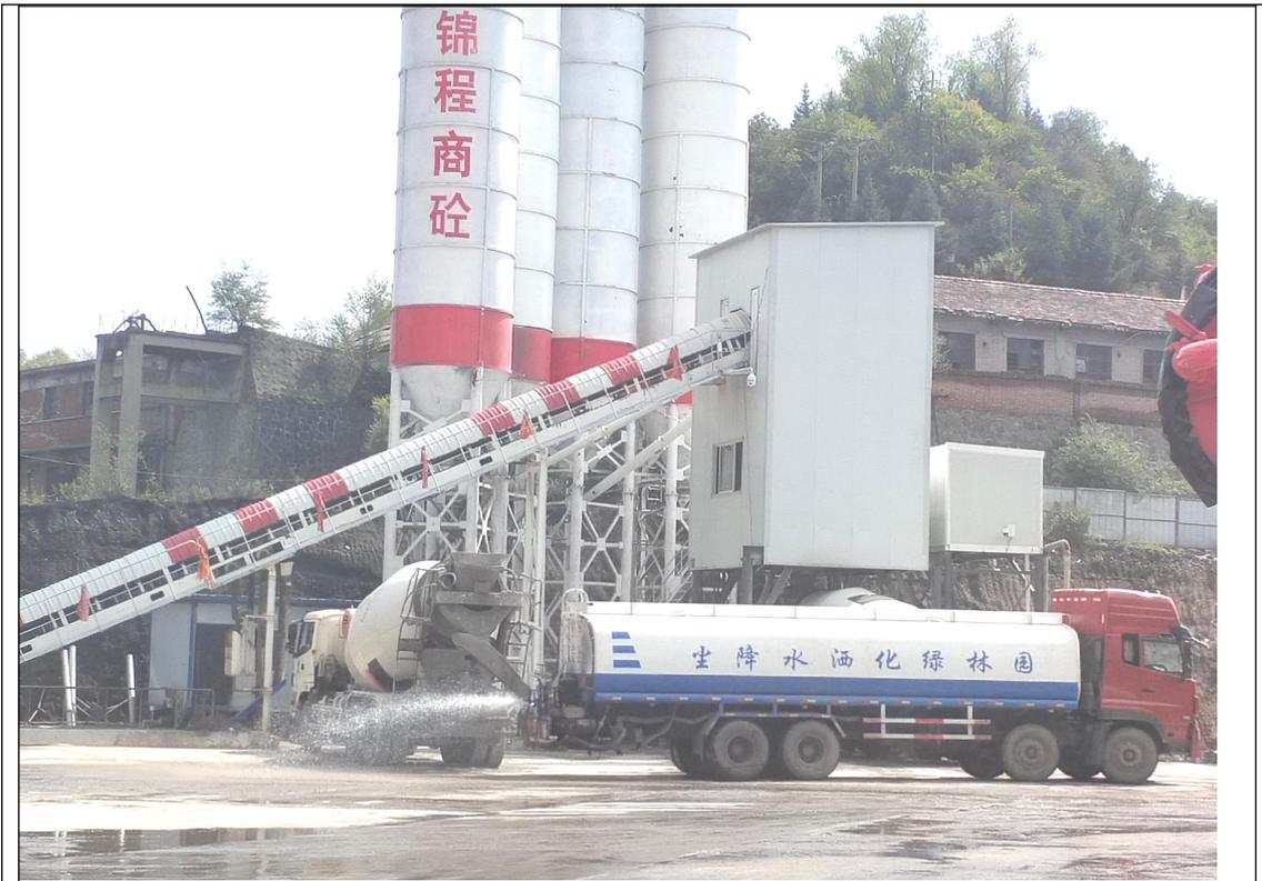
物料传送封闭廊道、封闭拌和料仓、洒水车
