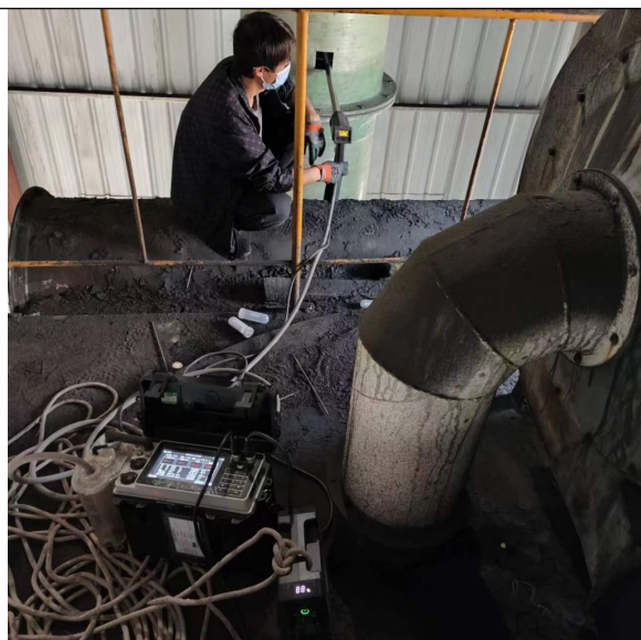
有组织废气排口采样孔
