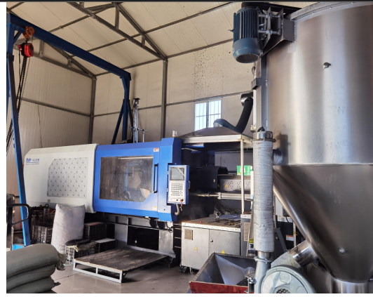
生产设备及废气收集口
